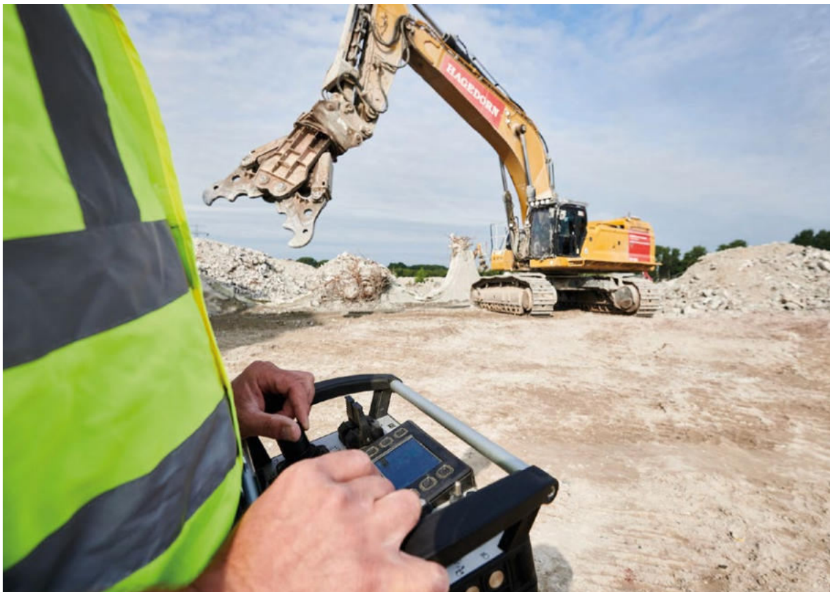
Cat Command in Form einer tragbaren Steuerkonsole
