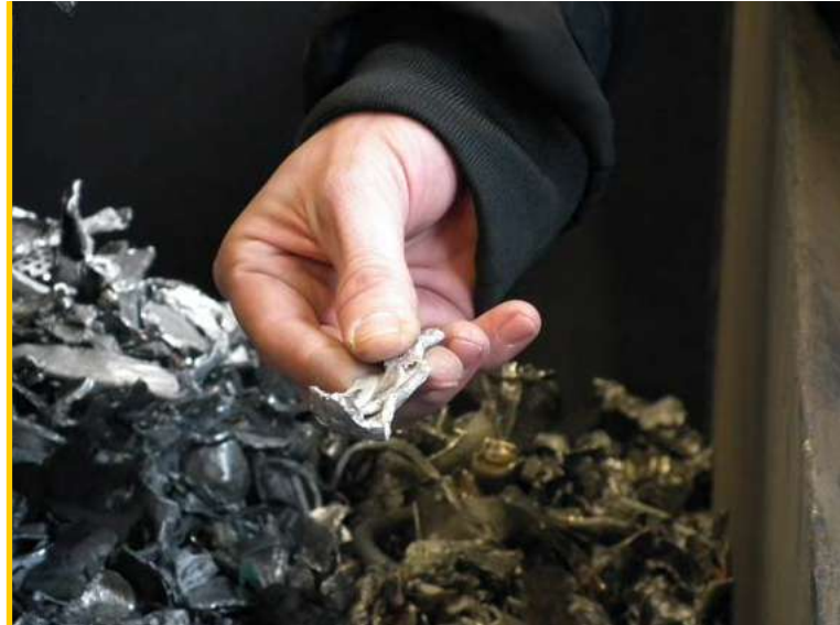
Die zerkleinerten Profile sind von Fremdmaterial und Anhaftungen befreit (Foto: AUF)
